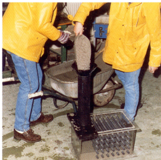
7.8 | Vessel-test, eveneens ter bepaling van de zelfverdichtendheid van betonspecie
