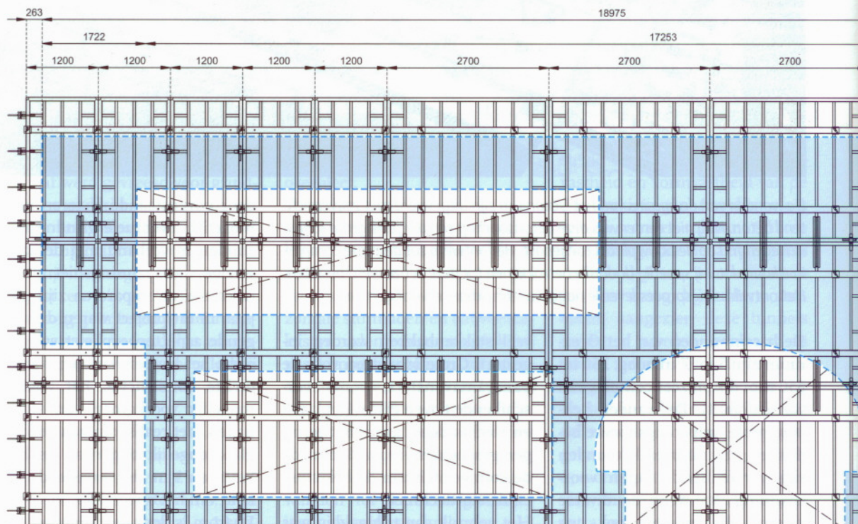
2 | Bekisting van de 'grote-gatenwand' van het haaienbassin. De betondoorsnede is blauw gerasterd
