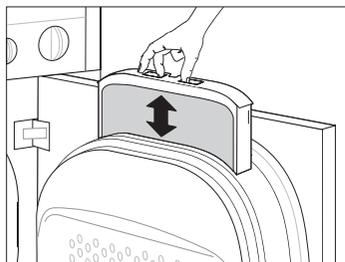
Bij gebruik van textielwaren slijten de vezels af (pluizen). Deze laten tijdens het drogen los en zetten zich in het filter vast.
