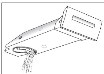
Deze droogautomaat werkt volgens het luchtcondensatieprincipe. Het vrijkomende condenswater wordt in een reservoir opgevangen. Dit reservoir moet na het drogen altijd geleegd worden.
