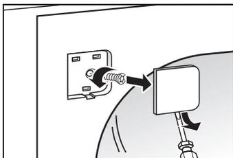
1. Beide afdekkingen van de deur-bevestigingspunten verwijderen: met een schroevendraaier voorzichtig eruit wippen.
