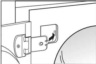
9. Beugels van de scharnieren in het front plaatsen, deur vasthouden.
