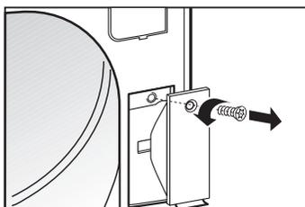
4. Schroef van de afdekking van de deursluiting eruit draaien. Afdekking eraf halen.
