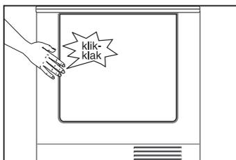
Door een druk op de "klik-klak"-sluiting kan de deur gemakkelijk geopend en gesloten worden.
