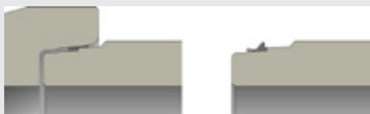
Glijverbinding, zonder glijmiddel
