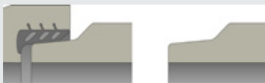
Glijverbinding met ingestort rubberprofiel
